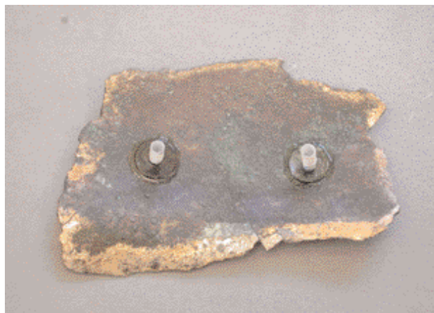
7 Auf die Rückseite des Fragments geklebte Schrauben aus Acrylglas ermöglichen die Montage am Träger.
