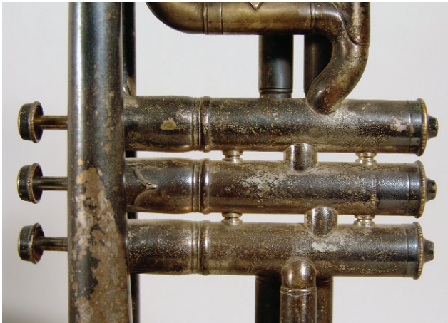
6 Sulfidierte Oberfläche des Kornetts MI 748
