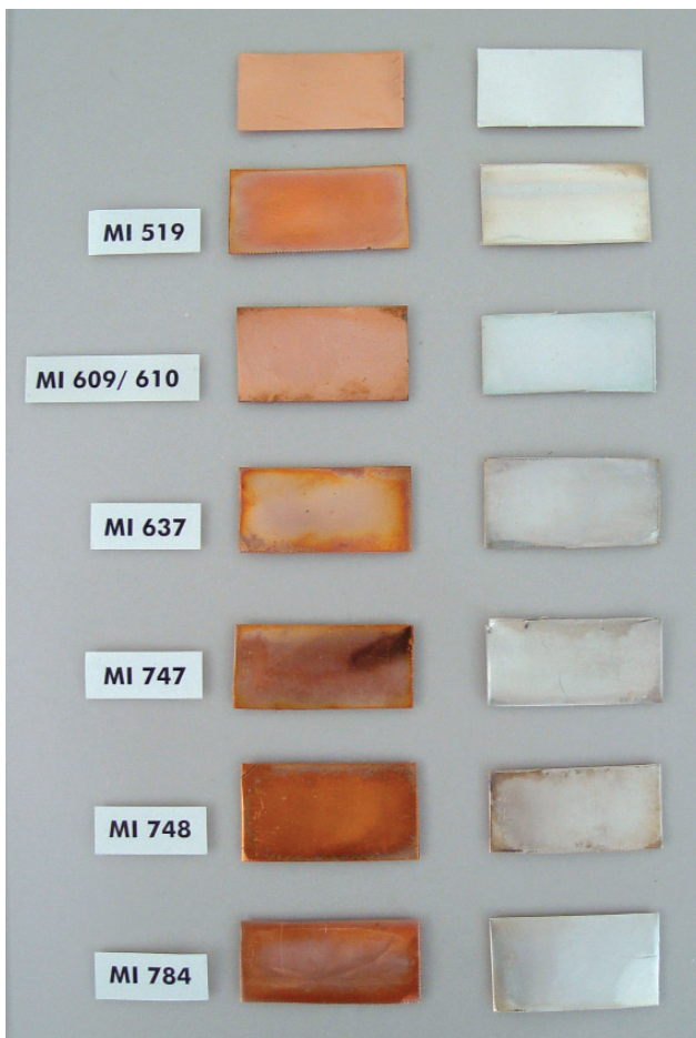
8 Metallprobenplättchen nach einer Expositionsdauer von 2 Jahren; oberste Reihe Referenzplättchen
