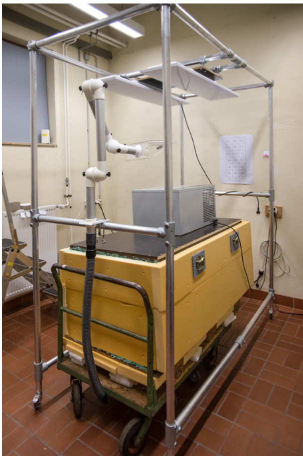
7 Blockbergung mit aufgesetztem mobilen Kühlelement und einem beweglichen Beleuchtungs- und Fotogestell. Während der Bearbeitungspausen wird der feuchte Grabbefund gekühlt.
