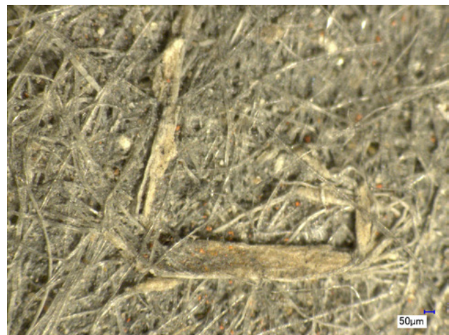
6 Aufnahme von Einschlussen bei der 1000-Kasch-Banknote mit der Inv.-Nr. 218/09 (Digitalmikroskop VHX-1000)
