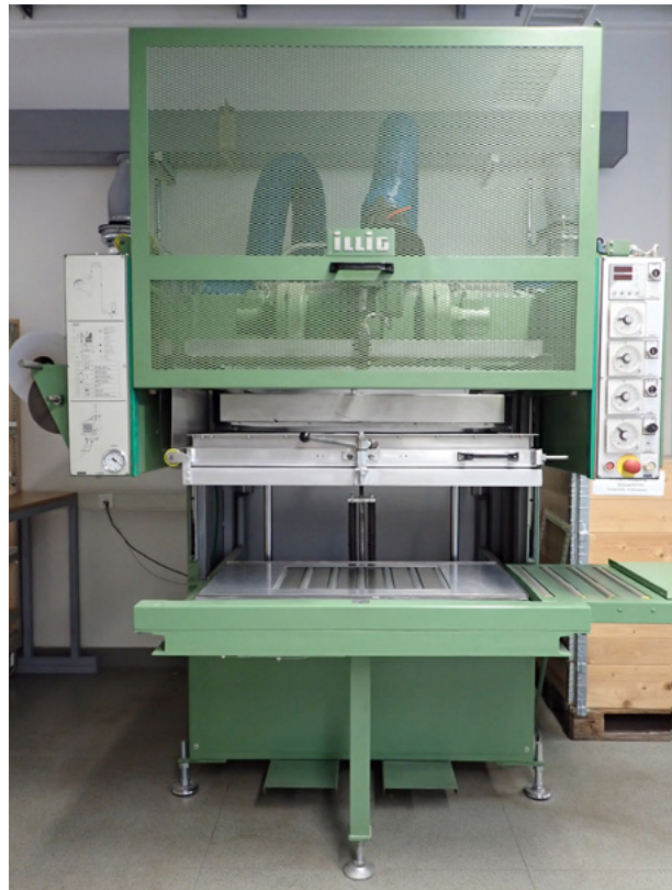
2 Skin-Maschine der Firma Illig in den Restaurierungswerkstätten der ASM
