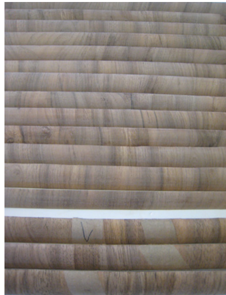
13 Intarsienkabinett, neu angefertigte furnierte Profilleisten für die Einfassung der Füllungen
