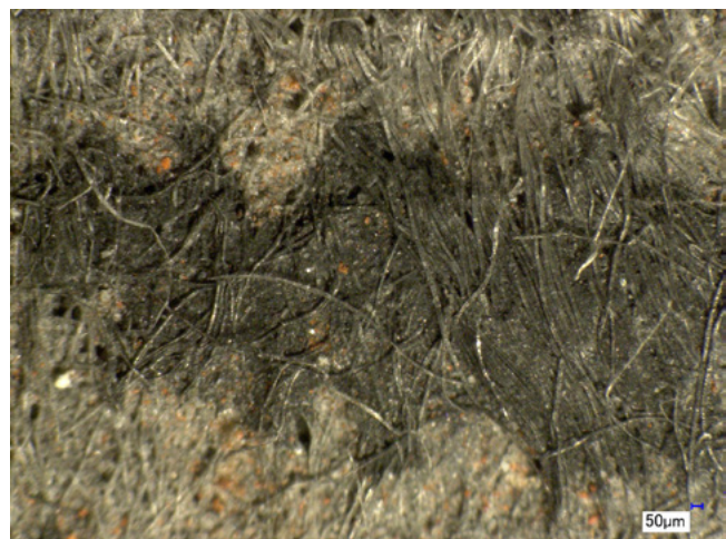
4 Aufnahme der Faserstruktur der 1000-Käsch-Note mit der Inv.-Nr. K05687 (Digitalmikroskop VHX-1000)
