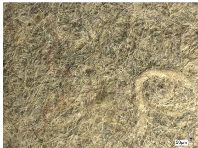
7 Aufnahme der Faserstruktur der 300-Käsch-Banknote mit der Inv.-Nr. 793/95 (Digitalmikroskop VHX-1000)
