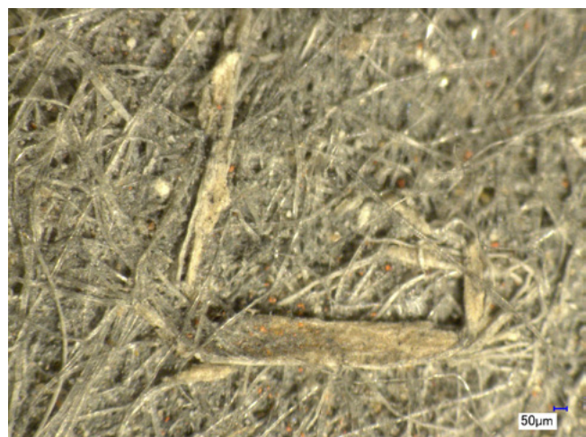
6 Aufnahme von Einschlüssen bei der 1000-Käsch-Banknote mit der Inv.-Nr. 218/09 (Digitalmikroskop VHX-1000)
