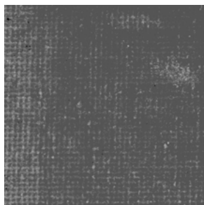
2 Reinigungsspur trockener Naturschwamm unter 30-facher Vergrößerung mit Tontrennung
