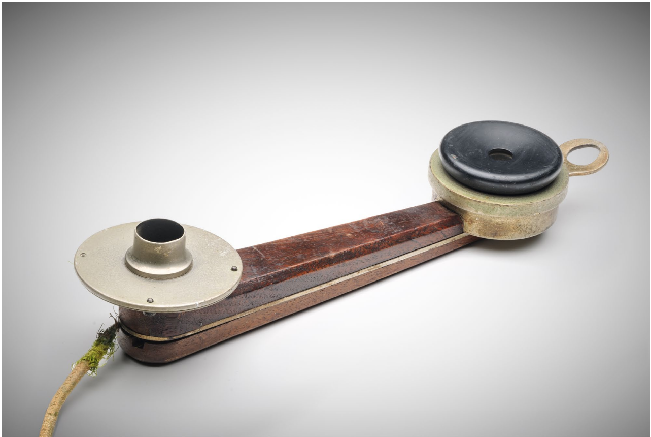
Abb.13: Mikrotelefon am „Feuer- und Unfall- melder Modell 1900“ im TECHNOSEUM Foto: Klaus Luginsland
